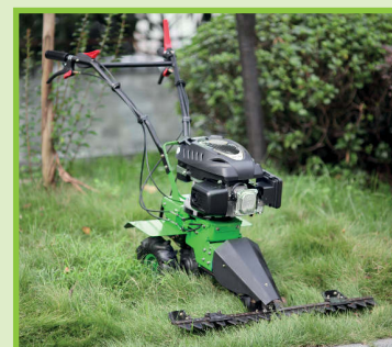
einsatzbereiter Balkenmäher Přestavba na lištovou sekačku
