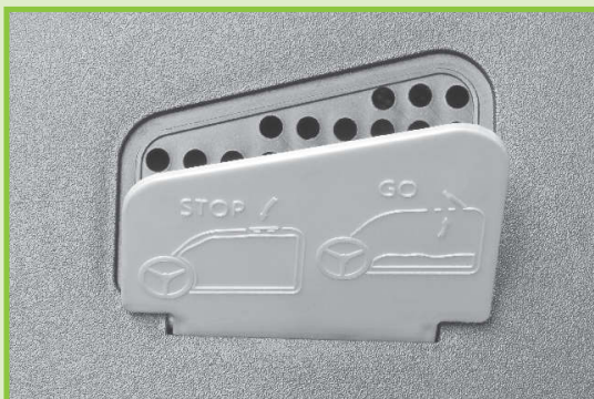
Füllanzeige des Korbes Ukazatel naplnění koše
