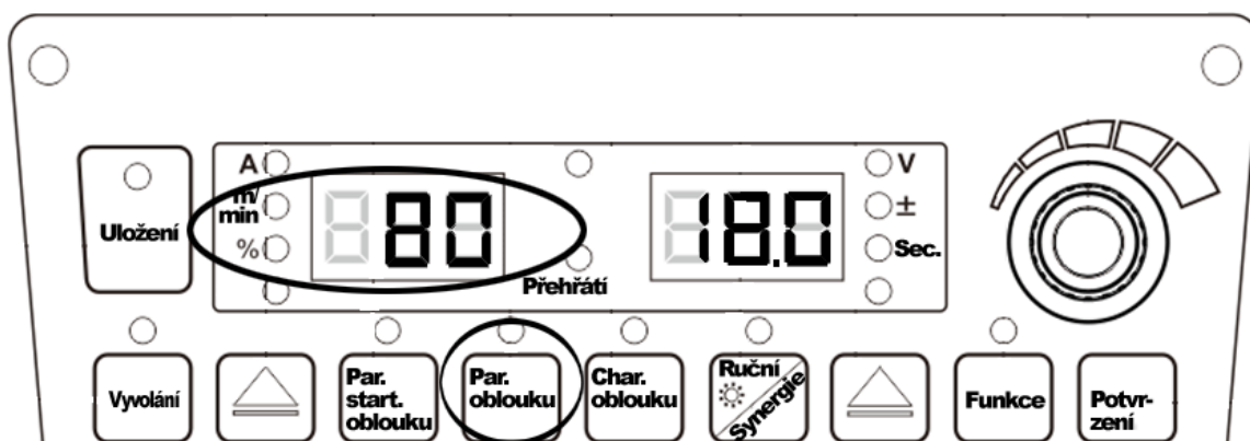
Obrázek 4-5 Rozhraní pro nastavení procenta parametru oblouku
