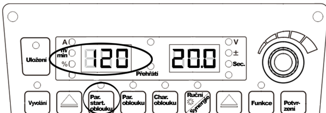
Obrázek 4-4 Rozhraní pro nastavení procenta parametru oblouku
