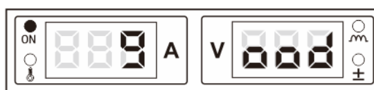
Obr. 3-13 Znaková výbojka (digitron) s nápisem „good“
