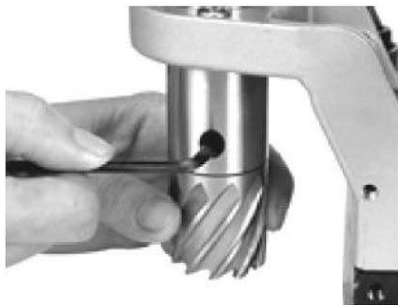
Obr. 12: Montáž jádrového vrtáku
