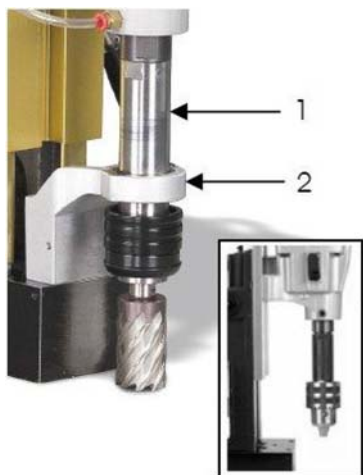
Obr. 15: Montáž vrtacího sklíčidla
