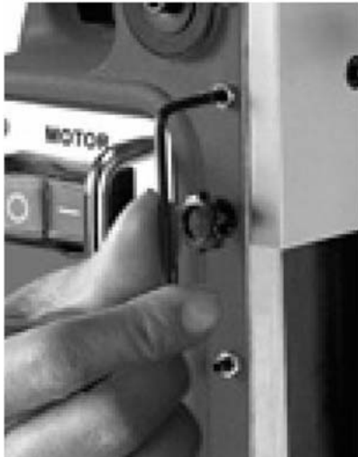
Obr. 23: Nastavení vůle ve vedení
