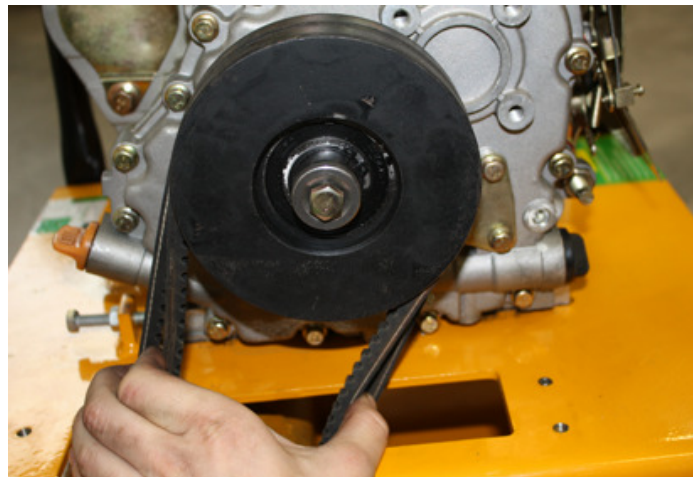
Obr. 2 Kontrola napnutí klínového řemene
