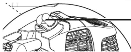
Distance des électrodes = 0,6 mm (distance entre les électrodes entre lesquelles l'étincelle d'allumage est générée). Après 10 heures de fonctionnement, vérifier pour la première fois que la bougie d'allumage n'est pas encrassée et la nettoyer avec une brosse métallique en cuivre si nécessaire.
