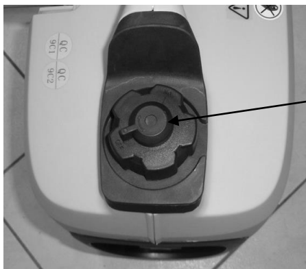
UZÁVĚR PALIVA S PŘEPÍNAČÍM KOHOUTEM
