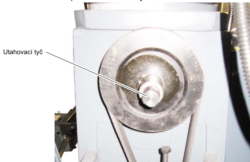
Obr. 4-20: Utahovací tyč pro horizontální frézování
