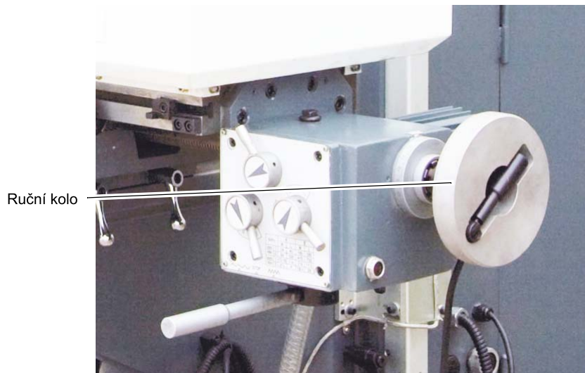
Obr. 4-12: Ruční posuv v ose X - Ruční kolo
