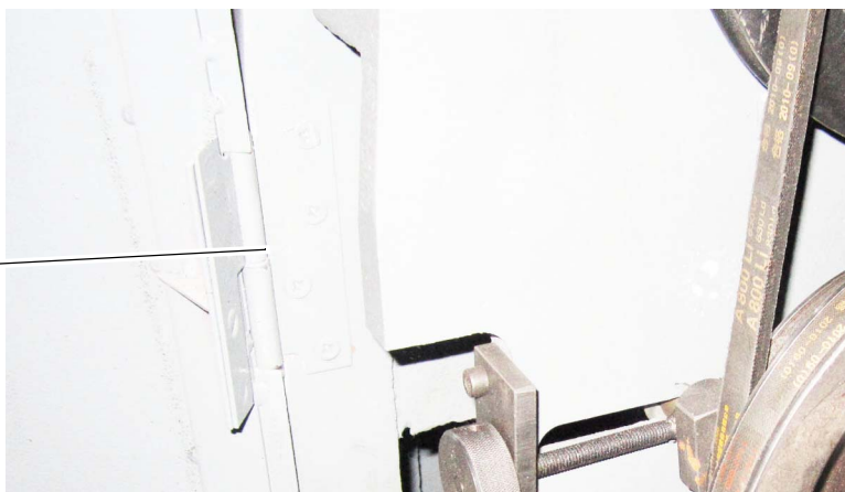
Obr. 4-3: Klínový řemen pro horizontální frézování
