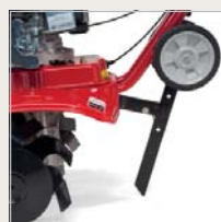
VE ZVEDNUTÉ POLOZE (V PRACOVNÍ POZICI) SLOUŽÍ ZÁVĚS KOLA JAKO VÝŠKOVĚ NASTAVITELNÁ OSTRUHA, JEN U MODELŮ T/205 A T/245
