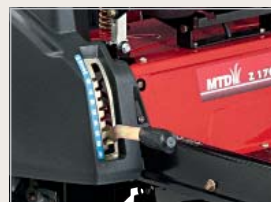
NASTAVENÍ VÝŠKY SEČENÍ & ELEKTROMAGNETICKÁ SPOJKA ŽACÍHO ÚSTROJÍ
