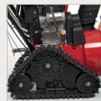
PÁSOVÝ POHON U OPTIMA ME 66 T
