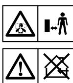
Im Betrieb entstehen giftige Gase, beispielsweise Kohlenmonoxid (ein farb- und geruchloses Gas), die zum Ersticken führen können. Generator nur an gut belüfteten Stellen im Freien verwenden.
