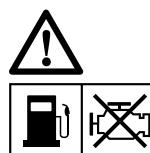
Wyłącz silnik i pozwól aby ostygł przed tankowaniem generatora. Paliwo jest niezwykle łatwopalne i pod pewnymi warunkami może być wybuchowe. Tankuj paliwa do generatora w dobrze wentylowanych pomieszczeniach upewniając się, że w pobliżu nie ma otwartego ognia, iskier i papierosów. Rozlane paliwo należy natychmiast sprzątać.
