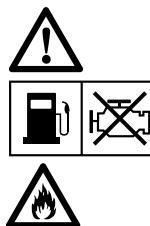
Prima di rifornire di carburante spegnere il motore e lasciarlo raffreddare. Il carburante è estremamente infiammabile ed in alcune condizioni può essere esplosivo. Rifornire di carburante solo in spazi ben aerati assicurandosi che non ci siano fiamme libere o sigarette accese. Ogni schizzo di carburante deve essere immediatamente asciugato.
