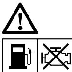
Motor vor dem Befüllen des Generators abschalten und abkühlen lassen. Kraftstoff ist leicht entzündlich und kann unter bestimmten Umständen sogar explodieren.
