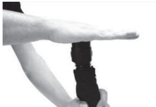
Obr. 15: Kontrola alarmu průtoku vzduchu
