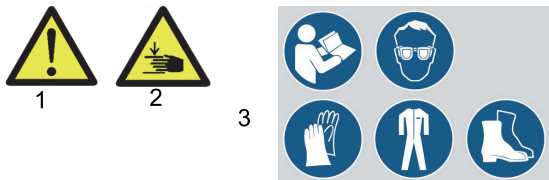
Obr. 1: 1 Pozor nebezpečí! | 2 Nebezpečí skřípnutí! | 3 Výstražný symbol
