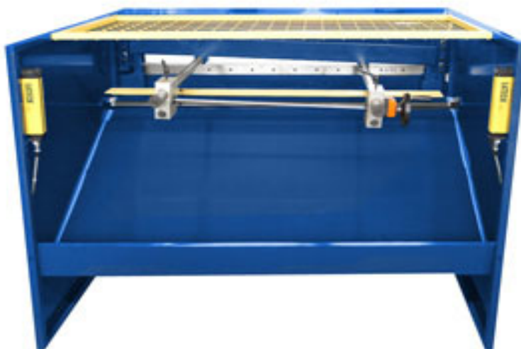
Obr. 6: Ochranný kryt na výstupu materiálu
