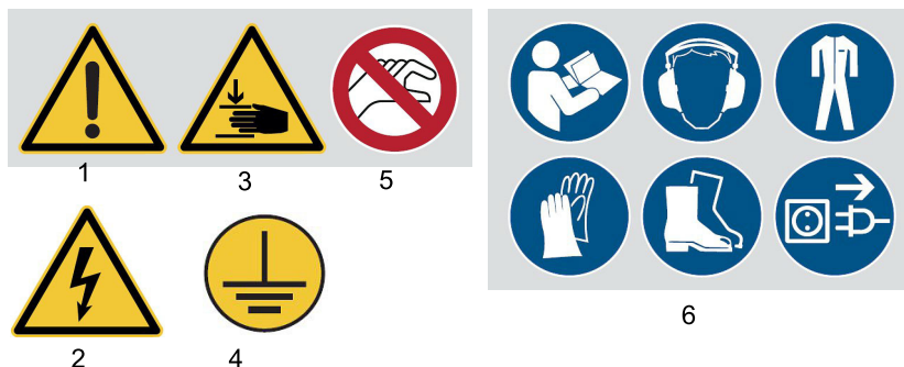
Obr. 1: Výstražné štítky - 1 Bezpečnostní pokyny, 2 Varování před nebezpečným elektrickým napětím, 3 Nebezpečí přímáknutí, 4 Symbol uzemnění, 5 Nezasahujte do stroje, 6 Pokyny: Přečtěte si návod k obsluze, Použijte ochranné brýle, Použijte pracovní oděv a obuv, Použijte ochranné rukavice, Vytáhněte zástrčku z elektrické sítě
