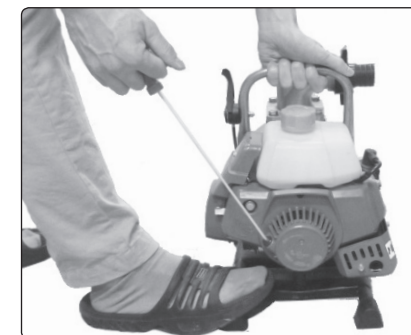
6. ábra. A szivattyú indítása
