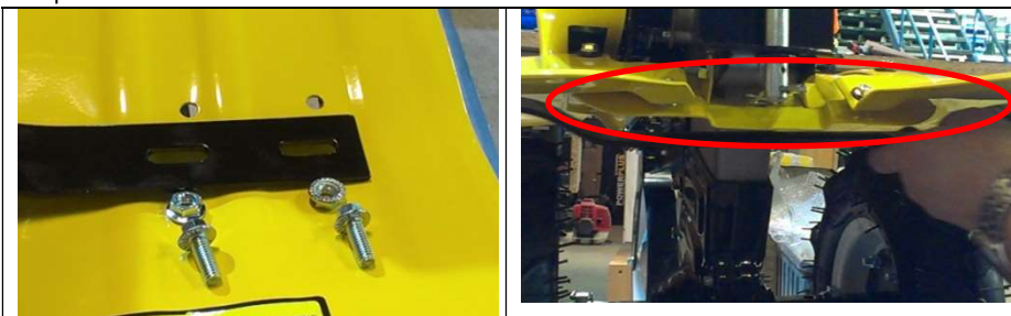
CS | Montáž opěry blatníku.
