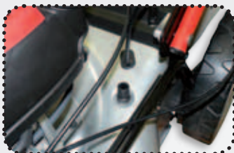
adaptér pro mytí podvozku sekačky
